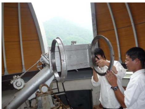
鏡筒をはずし、解体して修理しています。
